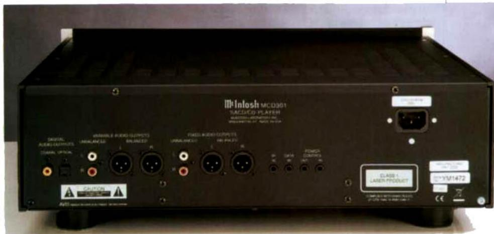
*Inusuale per un lettore di dischi ottici la dotazione di prese; il fatto è che l'MCD301 dispone di un regolatore di volume interno e pertanto è stato dotato di uscite a livello sia fisso che regolabile. Ciascuno dei due tipi, poi, è presente in formato single-ended e bilanciato.*
